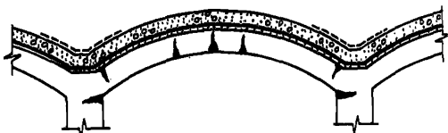
Рис.32. Трещины в ребристом своде со сводчатым перекрытием между ребрами и коррозия плиты над опорами
