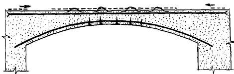
Рис. 34. Трещины в своде с горизонтальной верхней поверхностью, проскальзывание верхней арматуры на опорах, коррозия плиты и потеря сцепления арматуры с бетоном в пролете
