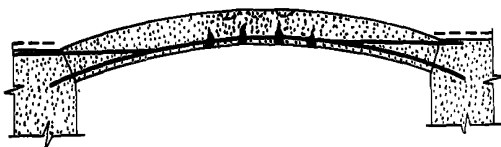
Рис.31. Характерные трещины (в растянутой зоне) железобетонного свода, проскальзывание арматуры на опорах, выкрашивание сжатой зоны бетона
