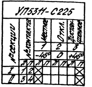
Диаграмма замыкания контактов конечных выключателей исполнительного механизма "УМ"
