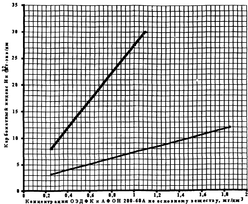
Рис.1. Область применения ОДФК, АФОН 200-60А и их аналогов, проверенных и сертифицированных в РАО «ЕЭС России», для систем теплоснабжения и ГВС при температуре 65-130 0 С и нагреве в сетевых подогревателях
