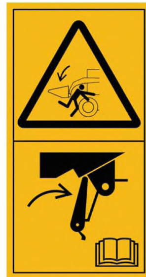
Рисунок С.10 — Раздавливание тела. Закрепи блокирующее устройство перед входом в опасную зону. Читай инструкцию по эксплуатации
