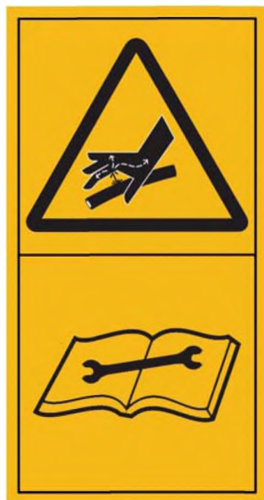
Рисунок С.17 — Жидкость под высоким давлением. Избегай жидкости под высоким давлением. Читай техническую документацию
