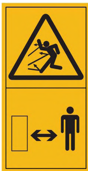
Рисунок С.6 — Брошенные или летящие предметы. Стой на безопасном расстоянии от источника опасности
