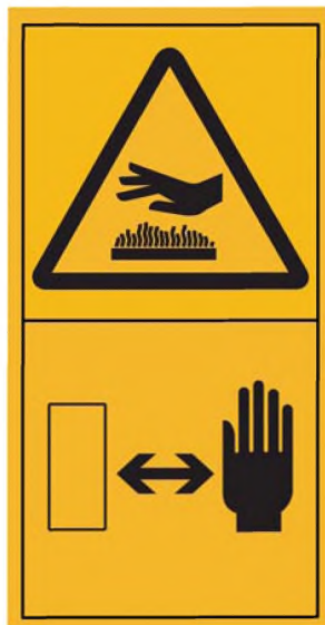
Рисунок С.16 — Горячая поверхность. Ожог пальцев или кисти. Держи руки на безопасном расстоянии от источника опасности
