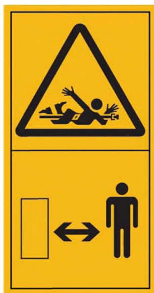
Рисунок С.26 — Затягивание тела в механизм. Стой на безопасном расстоянии от источника опасности
