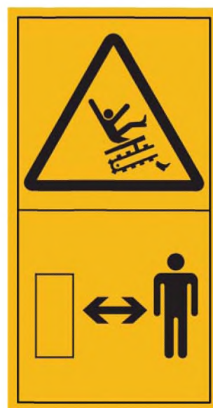
Рисунок С.27 — Затягивание ноги или ступни или их травматическая ампутация. Стой на безопасном расстоянии от источника опасности
