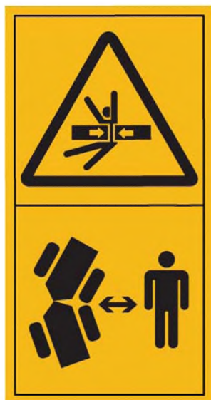
Рисунок С.3 — Раздавливание тела. Стой на безопасном расстоянии от зоны поворота машины с шарнирно-сочлененной рамой
