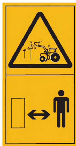
Рисунок С.13 — Электрошок или поражение электрическим током. Стой на безопасном расстоянии от линии электропередачи
