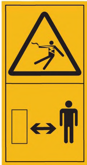
Рисунок С.14 — Электрошок или поражение электрическим током. Стой на безопасном расстоянии от источника электроэнергии
