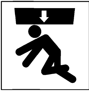
Рисунок А.13 — Раздавливание тела. Силовое воздействие сверху
