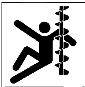
Рисунок А.33 — Затягивание кисти и руки. Шнек
