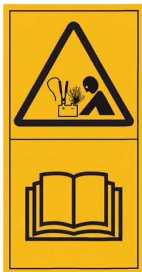
Рисунок С.19 — Взрыв аккумуляторной батареи при пуске от другого автомобиля. Читай инструкцию по эксплуатации
