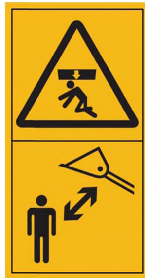
Рисунок С.2 — Раздавливание тела. Стой на безопасном расстоянии от поднятой стрелы и ковша погрузчика
