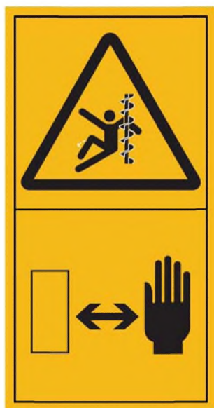
Рисунок С.25 — Затягивание руки или кисти в шнек. Держи руки и кисти на безопасном расстоянии от источника опасности
