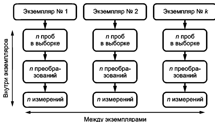
Рисунок 1 — Схема определения межэкземплярной неоднородности
