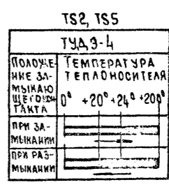
ДИАГРАММЫ РАБОТЫ РЕГУЛЯТОРОВ ТЕМПЕРАТУРЫ И ТЕРМОРЕГУЛИРУЮЩИХ УСТРОЙСТВ
