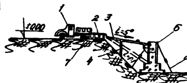
Рис.1 Схема бетонирования виброжелобами и вибропитателем только краинего ряда ленточных фундаментов
