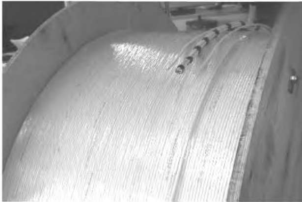
Рисунок 16 — Схема укладки кабелей на барабане
