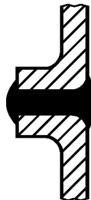
Рисунок А.13 — Зона разбрызгивания. Склепанное соединение
