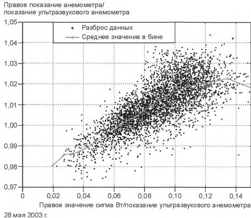
Рисунок J.8 — Пример анемометра, для которого не выполняется критерий наклона
