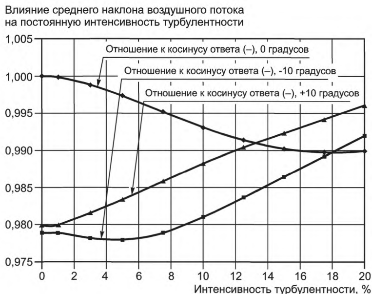
Рисунок J.7 — Общее отклонение от косинусной формы реакции для трех различных средних углов воздушного потока и интенсивности горизонтальной турбулентности
