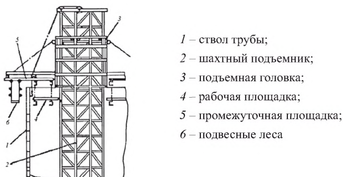
Рисунок 26 – Установка шахтного подъемника, площадок и подвесных лесов
