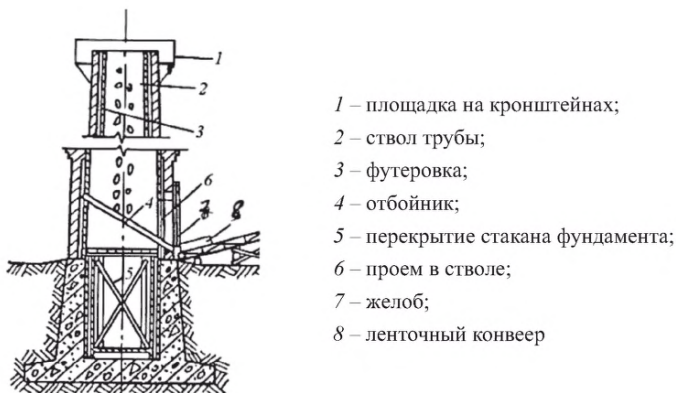
Рисунок 28 – Разрез кирпичной дымовой трубы с устройствами для ликвидации материалов от разборки
