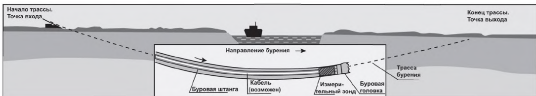
Рисунок 8.3 – Направленное бурение пилотной скважины
