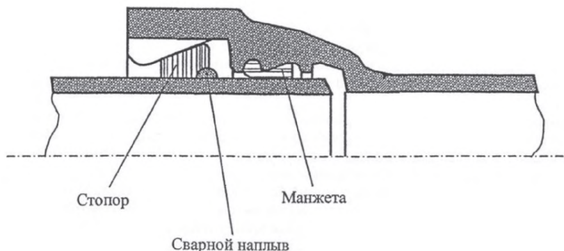
Рисунок 7.3 – Разрез раструбно-замкового соединения
