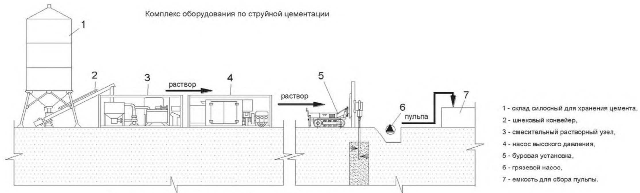
Технология стабилизации грунтов методом струйной цементации
