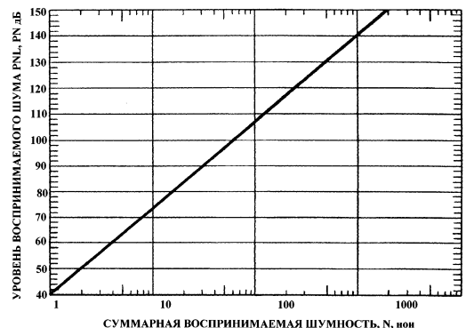
Рис. В1. Зависимость уровня воспринимаемого шума от суммарной воспринимаемой шумности
