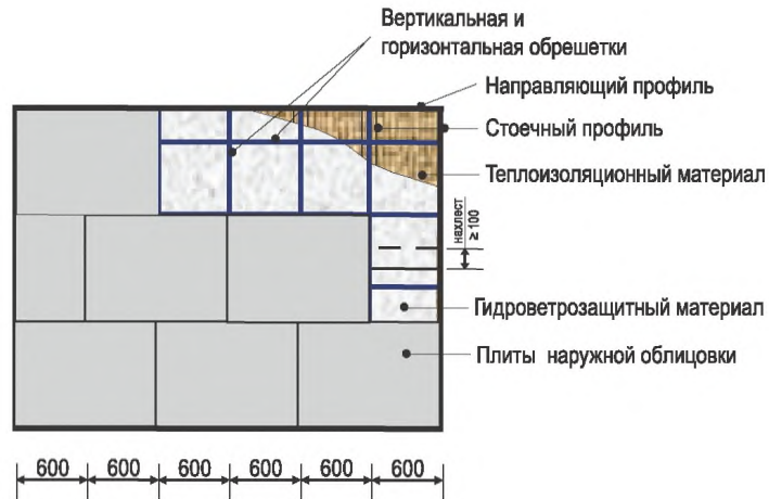
Рис. 13. Крепление наружной облицовки к каркасу
