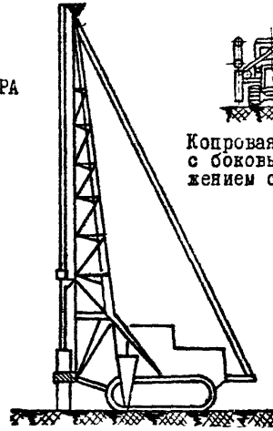
Копровая установка с хвостовым распо- ложением стрелы
