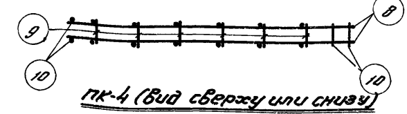
Пространственный каркас ПК-4
