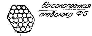
Обмотка пучка вязальной проволокой Ф1.5-2 500 витками через 1.5-2 м по длине
