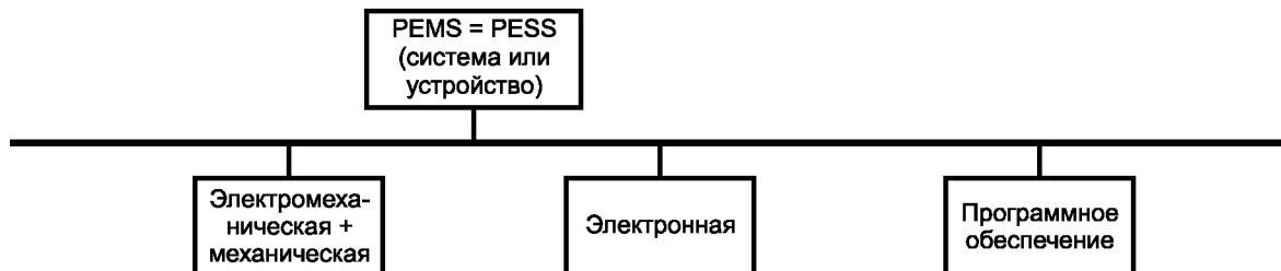
с) Пример самого простого исполнения PEMS
