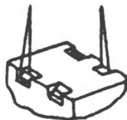
Рис. 2.7. Строповка порожнего контейнера за рымы, расположенные по диагонали
