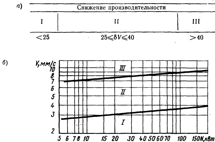
Рис. 9.1. Нормы снижения производительности (а) и нормы вибрации (б) поршневых компрессоров: I — хорошее состояние; II — удовлетворительное состояние; III — неудовлетворительное состояние
