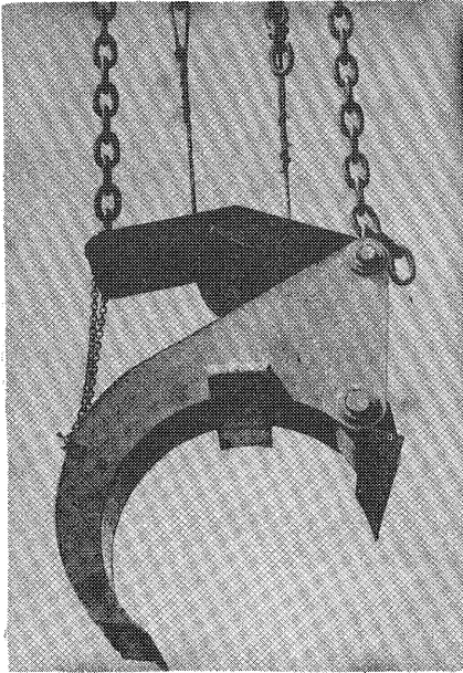
Рис. 1120.10. Крановый автоматический захват "Креветка" конструкции Белгород-Днестровского порта
