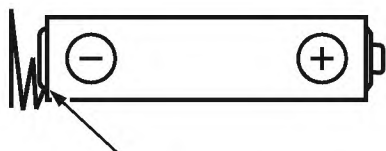
Рисунок В.10а – Пружина проскальзывает снизу оболочки – возможен контакт с металлом
