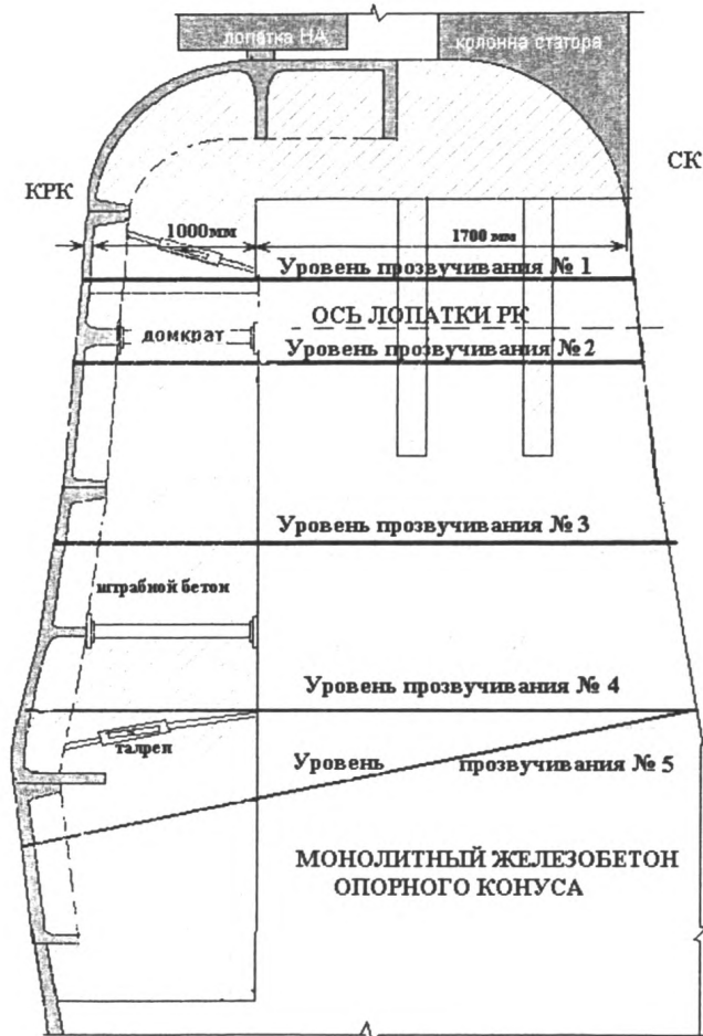
Рис. П4.1. Схема вертикального сечения направлений сквозной ультразвуковой локации опорного конуса КРК (через монолитный и штрабной бетон): ———— — трасса ультразвукового прозвучивания
