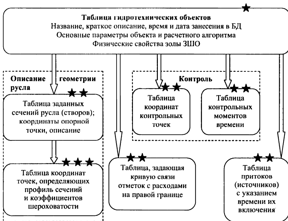
Рис.10. Структурная схема базы данных гидротехнических объектов (звездочками помечен уровень таблиц в БД)
