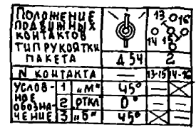
ДИАГРАММА ЗАМКНАНИЯ КОНТАКТОВ ПЕРЕКЛЮЧАТЕЛЯ SA3*
