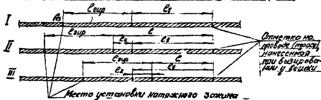
Рис. 37. Нанесение отметок на проводах (трасе) при визировании их без подъема на анкерно-угловую опору
