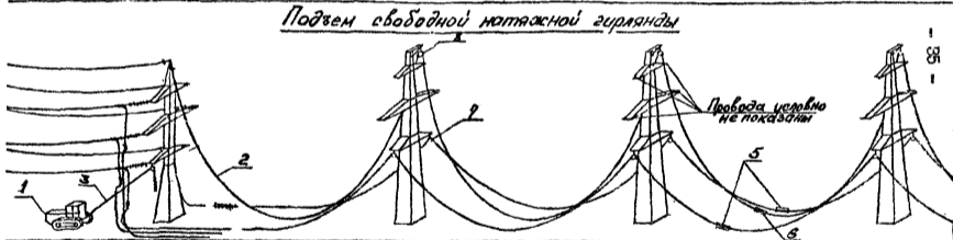
Рис. 11. Подъем натяжного крепления грозозащитного троса и натяжной гирлянды на анкерно-натяжную опору
