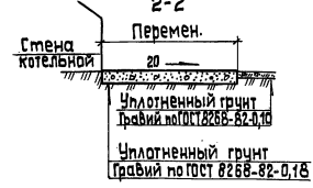
Конструктивные поперечные профили автодорог, площадок и тротуаров
