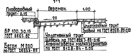
Конструктивные поперечные профили автодорог, площадок и тротуаров
