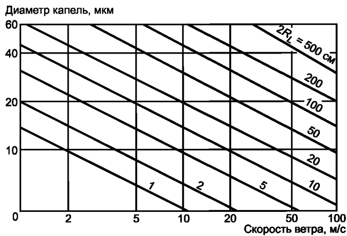
Рисунок 5 — Предельный радиус R_L цилиндра, при котором лед либо не образуется, либо образуется в малом количестве
