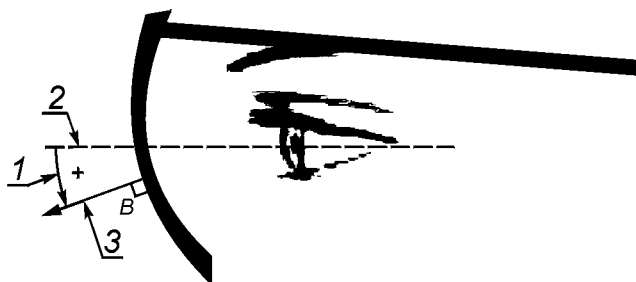
1 — пантоскопический угол носящего очки; 2 — исходное положение, принимаемое за горизонтальное; 3 — оптическая ось очковой линзы; B — горизонтальная средняя линия
