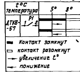
Диаграмма замыкания контактов датчиков температуры
