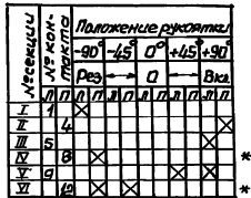
Диаграммы замыкания контактов переключателей 15-С1, 16-С1
