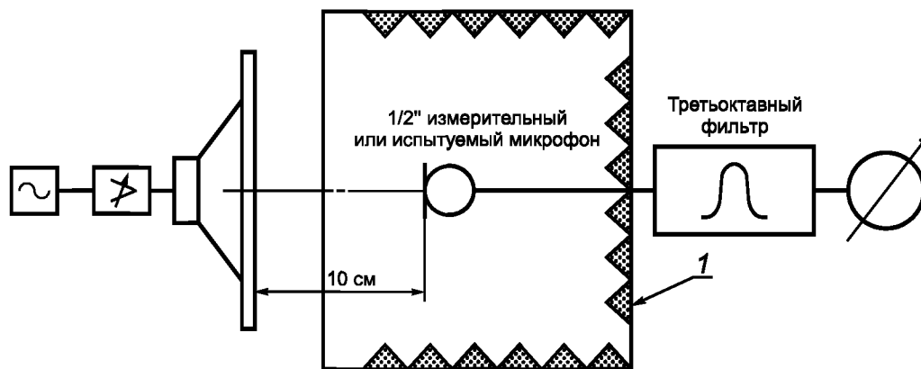
Рисунок ДБ.4 — Испытательная установка для измерения чувствительности по звуковому полю
