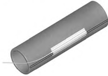
Рисунок 8 — Датчик ограничителя температуры на поверхности электроннагревателя
