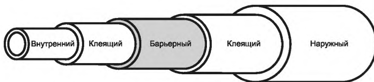
Рисунок 1 — Слои многослойной напорной трубы
