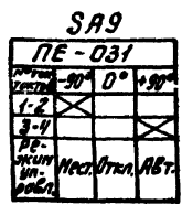
Диagramма замыкания контактов переключателя SA9
