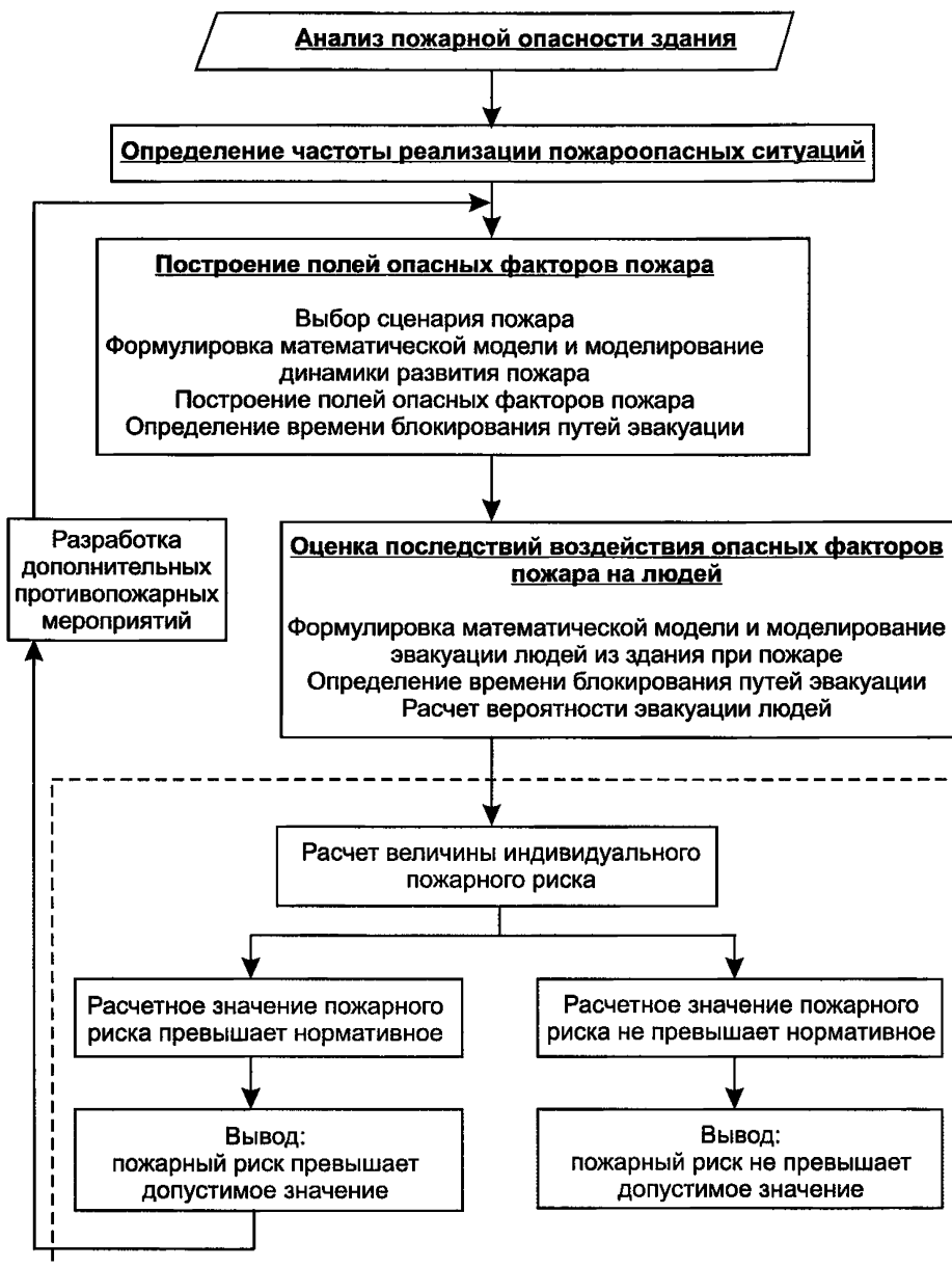
Рис. 1. Порядок проведения расчета индивидуального пожарного риска
