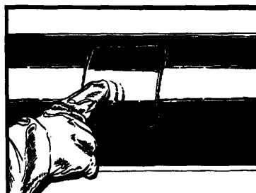
Рис. 6. Прикатка и уплотнение заплата на ремонтируемом участке
