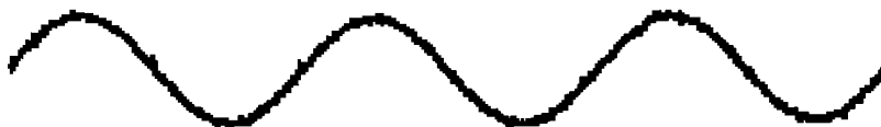
ПОМЕХА в виде синусоидальных колебаний базовой линии с частотой 0,3 Гц и амплитудой 0,5 мВ с наложенным высокочастотным шумом со среднеквадратическим значением напряжения 15 мкВ
