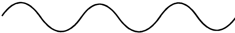
ПОМЕХА в виде синусоидальных колебаний базовой линии с частотой 0,3 Гц и амплитудой 0,5 мВ
