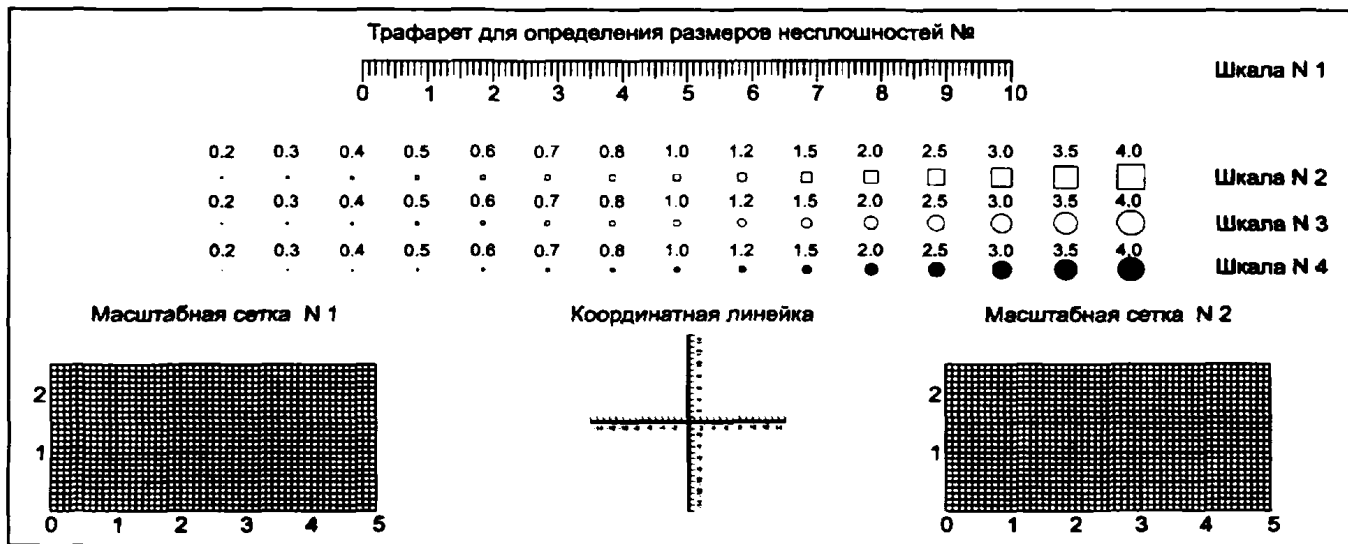
Рис. 1. Трафарет для оценки размеров изображений несплошностей
