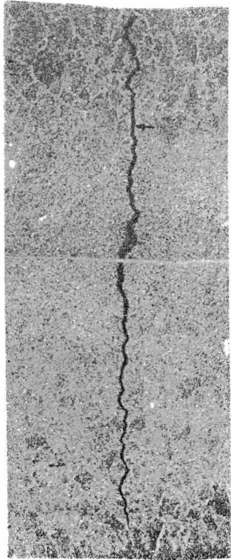
Рис. 24. Микротрещина в металле шва при автоматической дуговой сварке стали 10Г2ФР проволокой Св-08ГСМТ в газовой смеси \text{CO}_2 (85%) + \text{O}_2 (15%), травление в реактиве № 1 (см. табл. 2), 100\times
