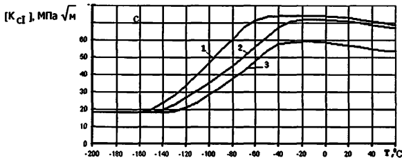
Рисунок Е4.1 - Температурная зависимость допускаемых значений коэффициента интенсивности напряжений для нормализованной стали 09Г2С
