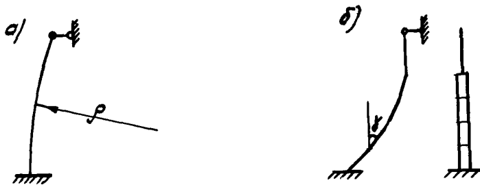
Рис. 9. Схема изогнутой оси колонны а - при изгибе; б - при сдвиге
