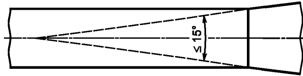
Рисунок В.1 — Конусный передающий элемент
