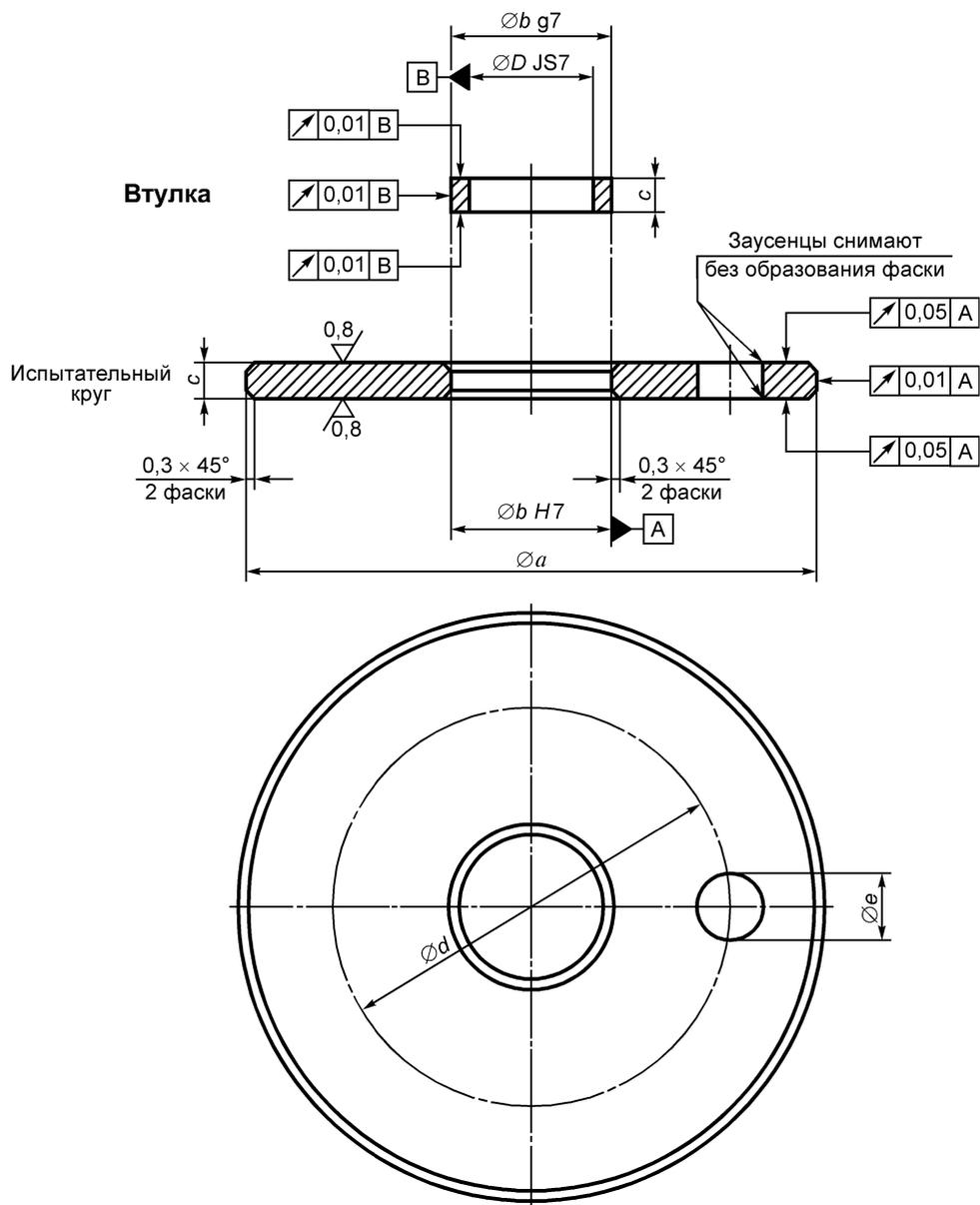
Рисунок 4 — Параметры испытательного круга и втулки
