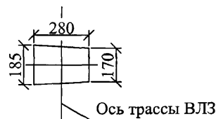
Схема установки стойки опоры
