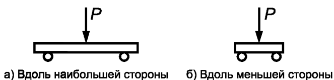
Рисунок 2 — Схема испытания модульного щита
