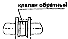
Установка бесфланцевого обратного клапана типа 194216р.
