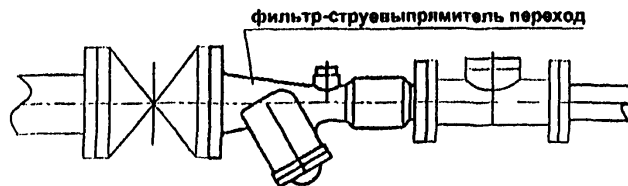
Установка фильтра-струевыпрямителя перехода перед турбинным счетчиком
