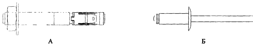
Рис.Б.11. Стальной анкерный дюбель (анкер) (А), заклепка вытяжная (Б).
