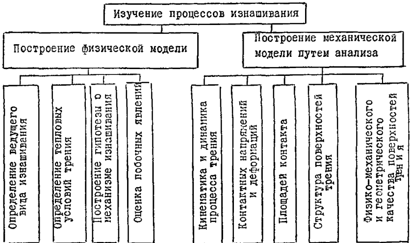
Рис. 1. Основные вопросы методики ускоренных испытаний при доминирующем влиянии процессов изнашивания.
